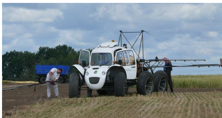
Рис. 2. Экспериментальная машина для опрыскивания посевов сельскохозяйственных растений в УНИЦ «Агротехнопарк» РГАТУ
