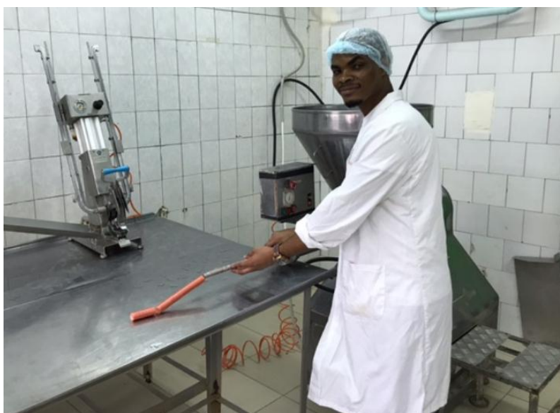
Рис. 5. Наполнение оболочек мясным фаршем при помощи шприца при изготовлении сосисок
