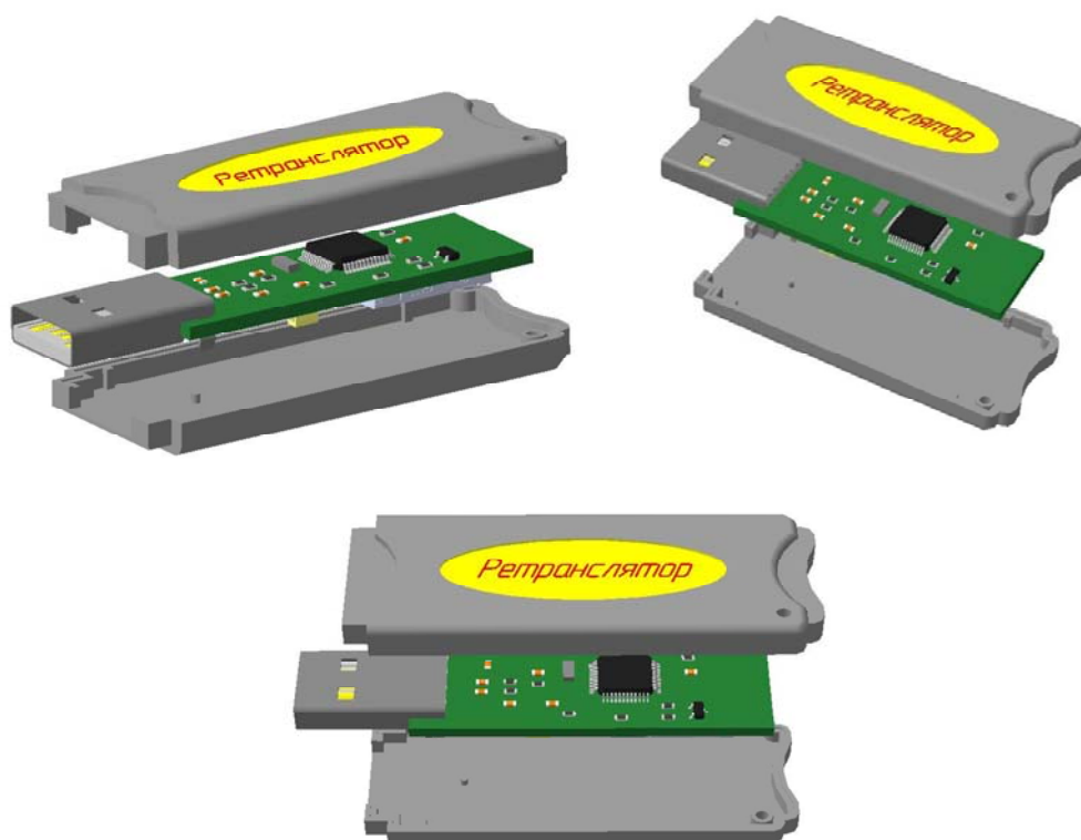
Рис. 2. Модель аппаратно-программного обеспечения симплексного ретранслятора
